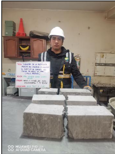
Fotografía N° 77: Testigos verticales convencionales a la compresión de los 14 días de edad, según referencia de la norma NTP 339.034 / ASTM C39
