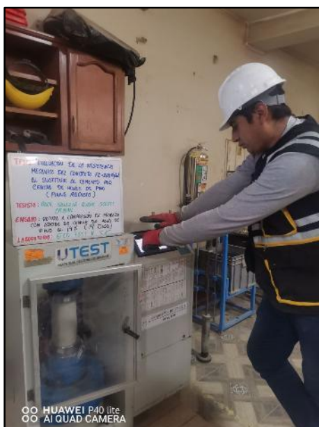
Fotografía N° 70: Testigos cilíndricos incorporados el 14% de ceniza de hojas de pino para la resistencia a la compresión de los 14 días de edad. NTP 339.034 / ASTM C39.
