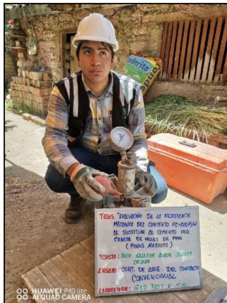
Fotografía N° 12: Control del contenido de aire del concreto fresco convencional por el método de presión. Según NTP 339.083
