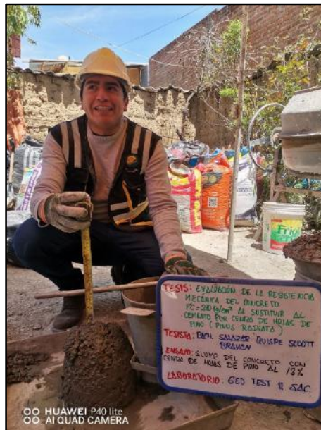
Fotografía N° 33: Medición del asentamiento del concreto fresco con adición del 12% de ceniza de hojas de pino. NTP 339.035.
