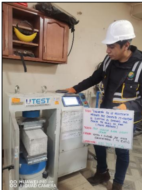
Fotografía N° 76: Testigos verticales convencionales para la resistencia a flexión de los 14 días de edad, según referencia de la norma NTP 339.034 / ASTM C39.
