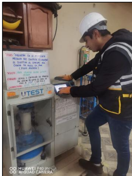
Fotografía N° 60: Testigos cilíndricos incorporados el 10% de ceniza de hojas de pino para la resistencia a la compresión de los 28 días de edad, según referencia de la norma NTP 339.034 / ASTM C39.
