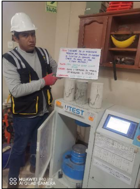
Fotografía N° 53: Testigos cilíndricos convencionales para la resistencia a la compresión de los 14 días de edad, según referencia de la norma NTP 339.034 / ASTM C39.
