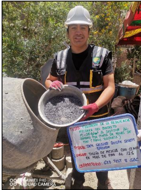
Fotografía N° 31: Vista particular de la ceniza de hojas de pino con peso requerido del 12% para su mezcla del concreto. NTP 339.183.
