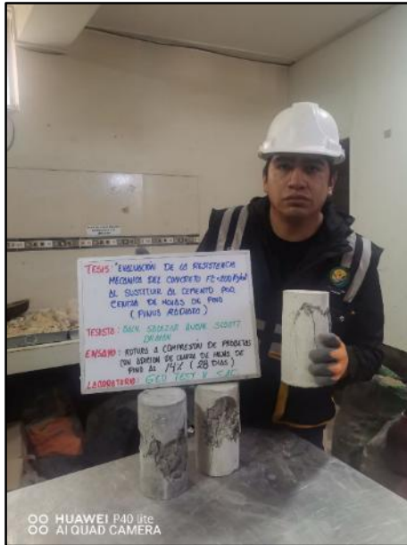
Fotografía N° 73: Testigos cilíndricos incorporados el 14% de ceniza de hojas de pino para la resistencia a la compresión de los 28 días de edad. NTP 339.034 / ASTM C39.
