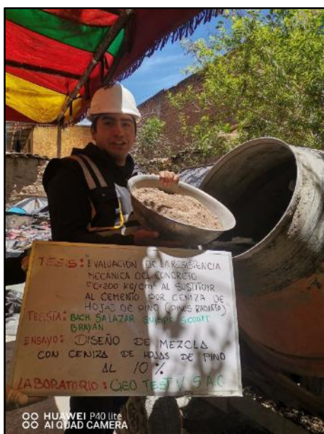
Fotografía N° 18: Vista de materiales tales como el agregado fino para la elaboración del concreto con 10% de ceniza de hojas de pino. NTP 339.183
