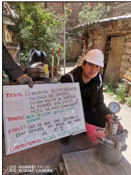
Fotografía N° 23: Control del contenido de aire del concreto fresco con adición del 10% de ceniza de hojas de pino por el método de presión. NTP 339.083.
