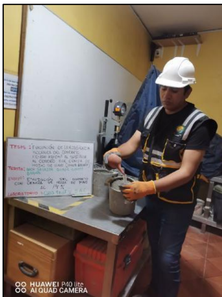
Fotografía N° 47: Control de la exudación del concreto con 14% de ceniza de hojas de pino, según referencia de la norma NTP 339.077.
