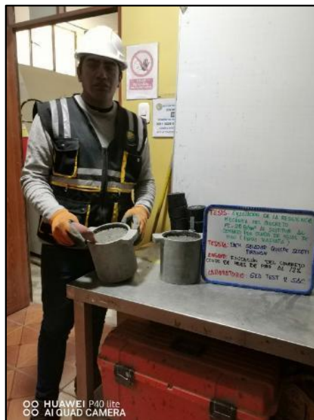
Fotografía N° 36: Control de la exudación del concreto con 12% de ceniza de hojas de pino, según referencia de la norma NTP 339.077.
