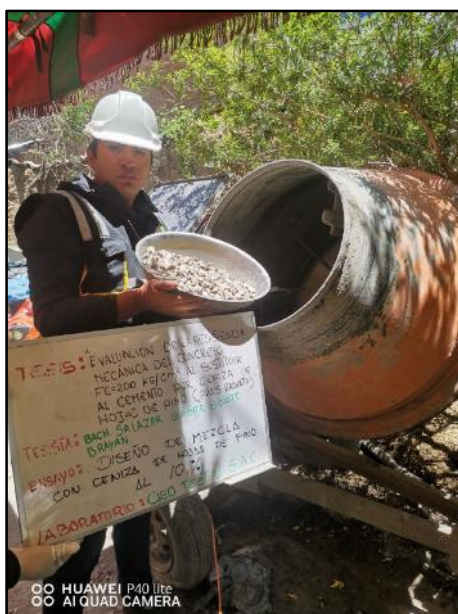
Fotografía N° 17: Vista de materiales tales como el agregado grueso para la elaboración del concreto con 10% de ceniza de hojas de pino. NTP 339.183.
