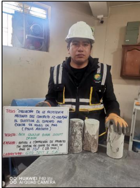
Fotografía N° 61: Testigos cilíndricos incorporados el 10% de ceniza de hojas de pino para la resistencia a los 28 días de edad, según norma NTP 339.034 / ASTM C39
