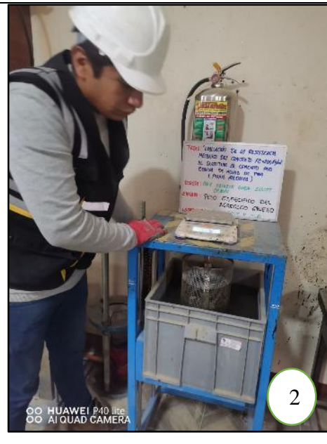
Fotografía N° 3: Ensayo peso específico (2) y absorción (1) del agregado grueso. NTP 400.022.
