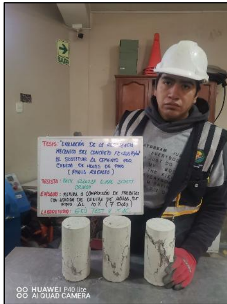
Fotografía N° 57: Testigos cilíndricos incorporados el 10% de ceniza de hojas de pino para la resistencia a la compresión de los 7 días de edad, según referencia de la norma NTP 339.034 / ASTM C39
