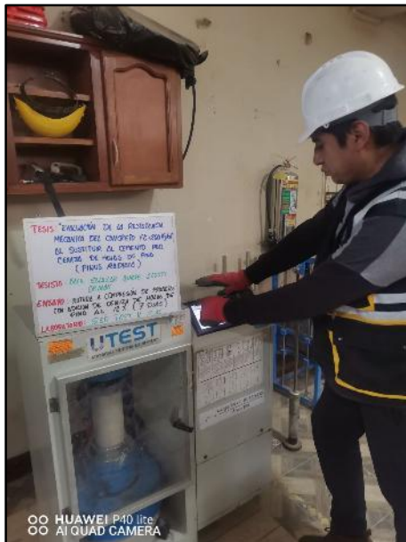
Fotografía N° 62: Testigos cilíndricos incorporados el 12% de ceniza de hojas de pino para la resistencia a la compresión de los 7 días de edad. NTP 339.034 / ASTM C39.
