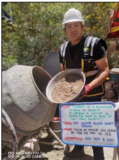
Fotografía N° 30: Vista de materiales tales como el agregado fino para la elaboración del concreto con adición del 12% de ceniza de hojas de pino. NTP 339.183.
