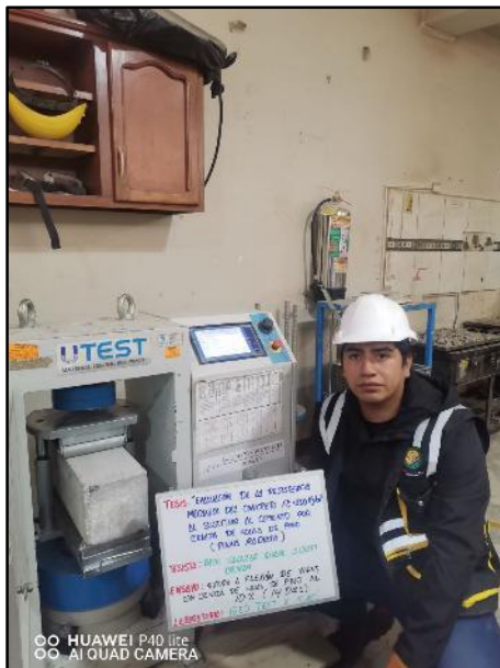
Fotografía N° 82: Testigos cilíndricos incorporados 10% de ceniza de hojas de pino para la resistencia a la flexión de los 14 días de edad, según referencia de la norma NTP 339.034 / ASTM C39.
