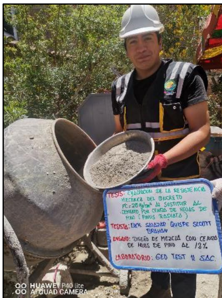
Fotografía N° 28: Vista de materiales tales como el cemento para la elaboración del concreto con adición del 12% de ceniza de hojas de pino. NTP 339.183.
