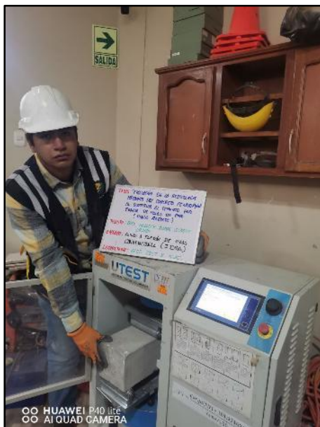
Fotografía N° 74: Testigos verticales convencionales para la resistencia a flexión de los 7 días de edad, según referencia de la norma NTP 339.034 / ASTM C39.
