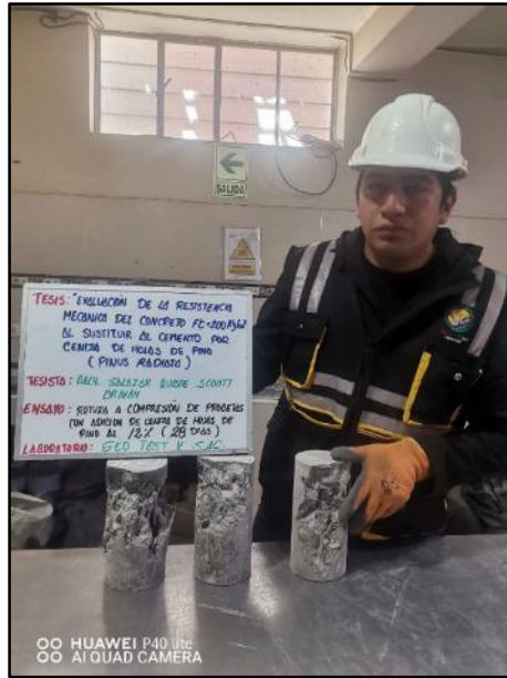
Fotografía N° 67: Testigos cilíndricos incorporados el 12% de ceniza de hojas de pino para la resistencia a la compresión de los 28 días de edad. NTP 339.034 / ASTM C39.
