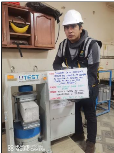
Fotografía N° 78: Testigos verticales convencionales para la resistencia a flexión de los 28 días de edad, según referencia de la norma NTP 339.034 / ASTM C39.
