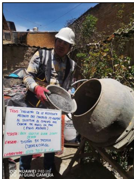
Fotografía N° 6: Vista de materiales tales como el cemento para la elaboración del concreto convencional, según referencia de la norma NTP 339.183.
