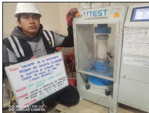
Fotografía N° 68: Testigos cilíndricos incorporados el 14% de ceniza de hojas de pino para la resistencia a la compresión de los 7 días de edad, según referencia de la norma NTP 339.034 / ASTM C39.
