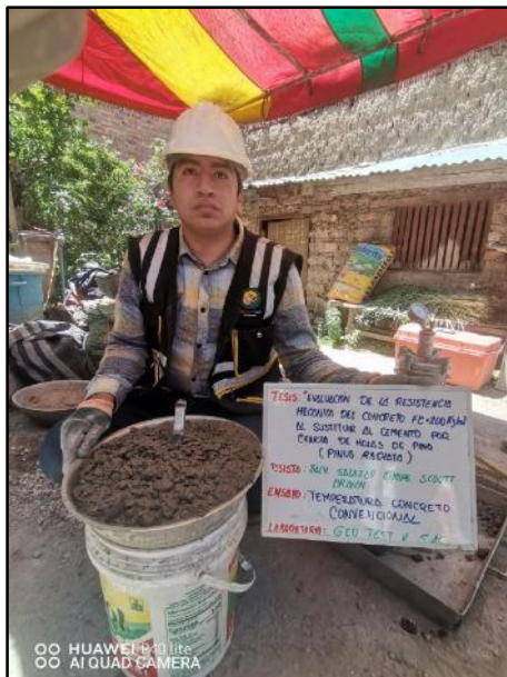
Fotografía N° 10: Medición de la temperatura del concreto saliendo de la mezcladora convencional, según referencia de la norma NTP 339.184.
