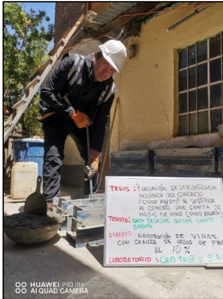
Fotografía N° 27: Elaboración de testigos rectangulares con adición del 10% de ceniza de hojas de pino para sus respectivos tipos de ensayos. NTP 339.034 / ASTM C39.
