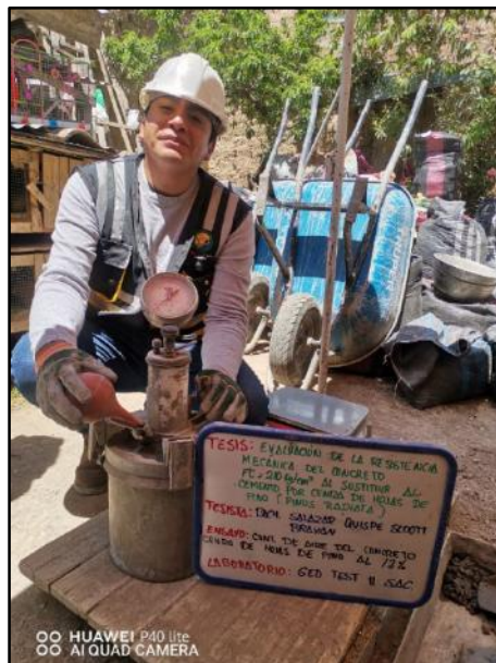
Fotografía N° 34: Control del contenido de aire del concreto fresco con adición del 12% de ceniza de hojas de pino por el método de presión. Según NTP 339.083.
