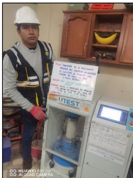
Fotografía N° 58: Testigos cilíndricos incorporados 10% de ceniza de hojas de pino para la resistencia a la compresión de los 14 días de edad, según referencia de la norma NTP 339.034 / ASTM C39.
