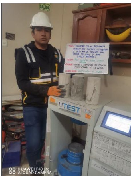
Fotografía N° 55: Testigos cilíndricos convencionales para la resistencia a la compresión de los 28 días de edad, según referencia de la norma NTP 339.034 / ASTM C39.
