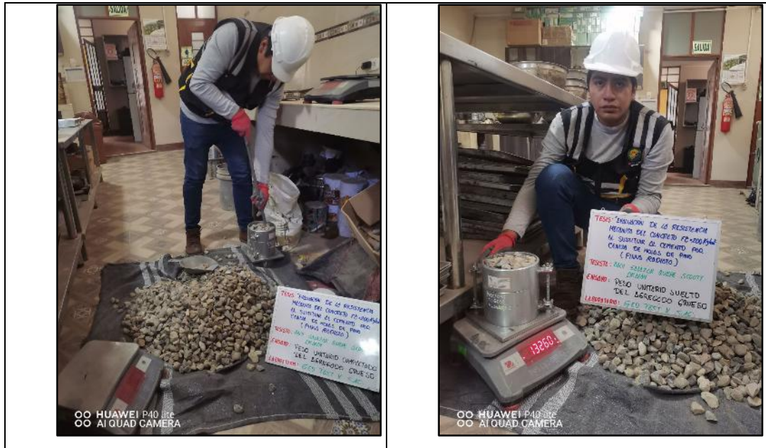
Fotografía N° 5: Ensayo de Peso unitario compactado y suelto del agregado grueso. NTP 400.017.
