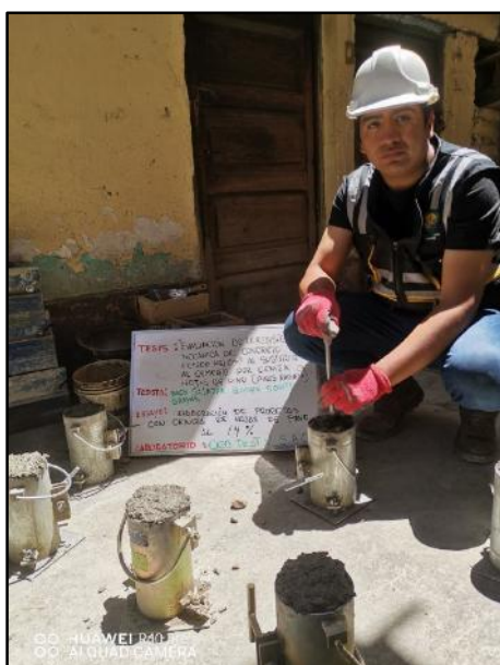
Fotografía N° 48: Elaboración de testigos cilíndricos con adición del 14% de ceniza de hojas de pino para sus respectivos tipos de ensayos, según referencia de la norma NTP 339.034 / ASTM C39.
