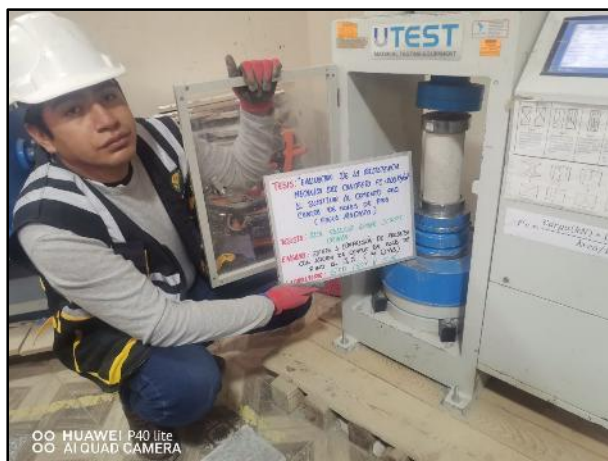
Fotografía N° 64: Testigos cilíndricos incorporados el 12% de ceniza de hojas de pino para la resistencia a la compresión de los 14 días de edad, según referencia de la norma NTP 339.034 / ASTM C39.
