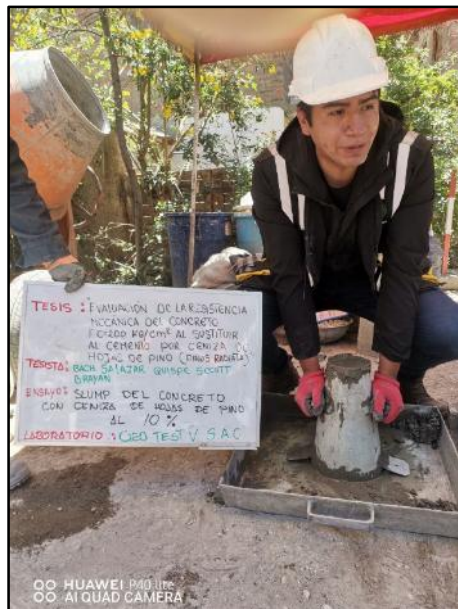
Fotografía N° 22: Medición del asentamiento del concreto fresco con adición del 10% de ceniza de hojas de pino. NTP 339.035.
