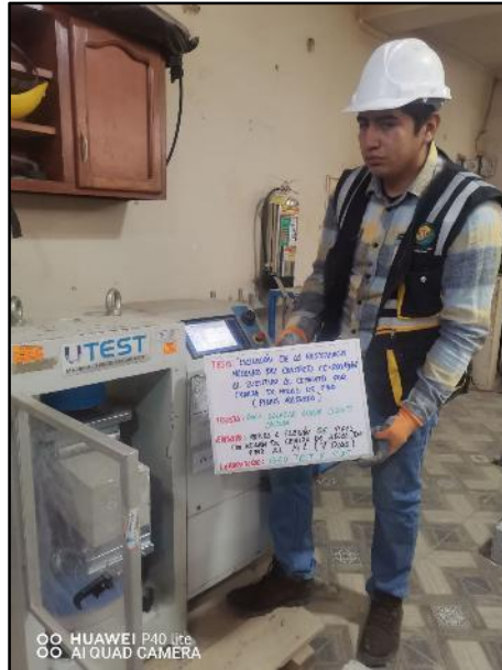
Fotografía N° 89: Testigos cilíndricos incorporados el 14% de ceniza de hojas de pino expandido para la resistencia a la flexión de los 7 días de edad. NTP 339.034 / ASTM C39.
