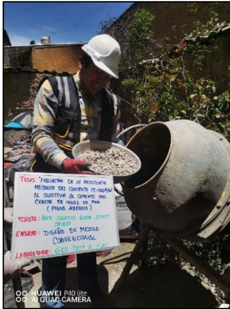
Fotografía N° 7: Vista de materiales tales como el agregado grueso para la elaboración del concreto convencional, según referencia de la norma NTP 339.183.
