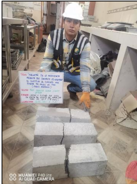
Fotografía N° 81: Testigos cilíndricos incorporados el 10% de ceniza de hojas de pino para la resistencia a flexión de los 7 días de edad. NTP 339.034 / ASTM C39.
