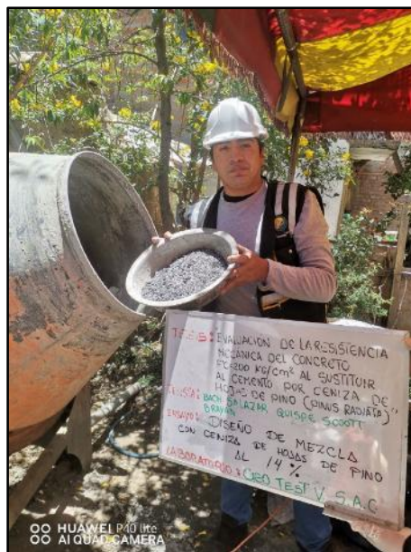
Fotografía N° 42: Vista de materiales tales como la ceniza de hojas de pino para la elaboración del concreto con adición del 14%. NTP 339.183
