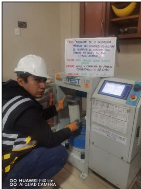
Fotografía N° 54: Testigos cilíndricos convencionales para la resistencia a la compresión de los 28 días de edad, según referencia de la norma NTP 339.034 / ASTM C39.
