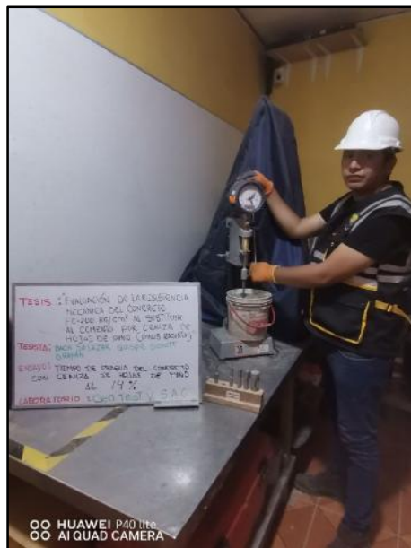
Fotografía N° 46: Control de penetración de diferentes diámetros de agujas para la verificación de tiempo para el fraguado con adición del 14% de ceniza de hojas de pino, según referencia de la norma NTP 400.037.
