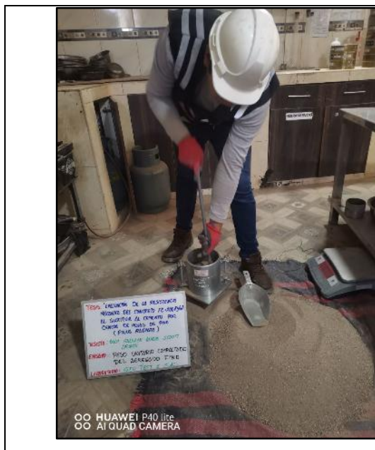
Fotografía N° 4: Ensayo de Peso unitario compactado y suelto del agregado fino. NTP 400.017.
