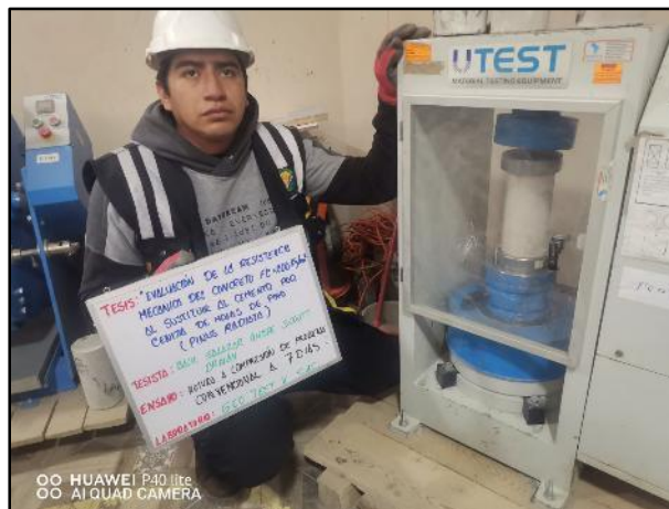
Fotografía N° 50: Testigos cilíndricos convencionales para la resistencia a la compresión de los 7 días de edad, según referencia de la norma NTP 339.034 / ASTM C39.
