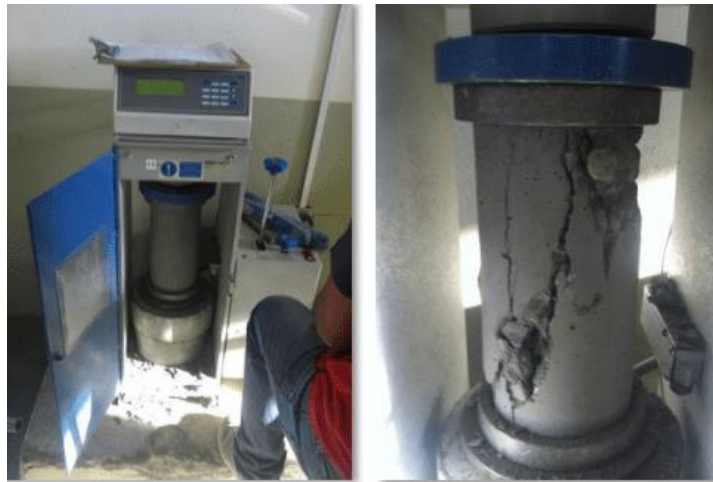
Figura N° 12. Ensayo de la resistencia a la compresión
