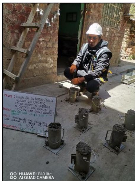
Fotografía N° 26: Elaboración de testigos cilíndricos con adición del 10% de ceniza de hojas de pino para sus respectivos tipos de ensayos, según referencia de la norma NTP 339.034 / ASTM C39.
