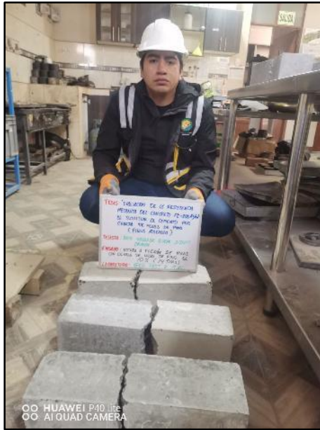
Fotografía N° 83: Testigos cilíndricos incorporados el 10% de ceniza de hojas de pino para la resistencia a la flexión de los 14 días de edad, según referencia de la norma NTP 339.034 / ASTM C39.
