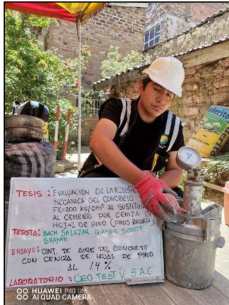
Fotografía N° 45: Control del contenido de aire del concreto fresco con adición del 14% de ceniza de hojas de pino por el método de presión. Según NTP 339.083.
