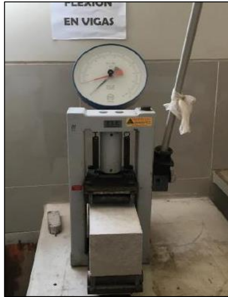
Figura N° 15. Ensayo de resistencia a la flexión en vigas de concreto
