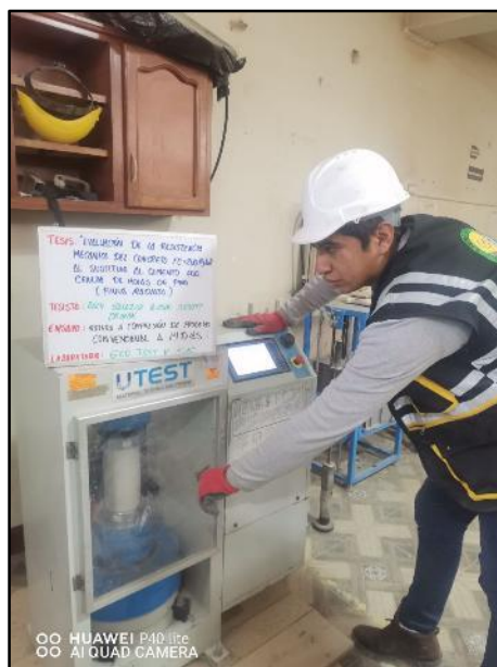
Fotografía N° 52: Testigos cilíndricos convencionales para la resistencia a la compresión de los 14 días de edad, según referencia de la norma NTP 339.034 / ASTM C39.
