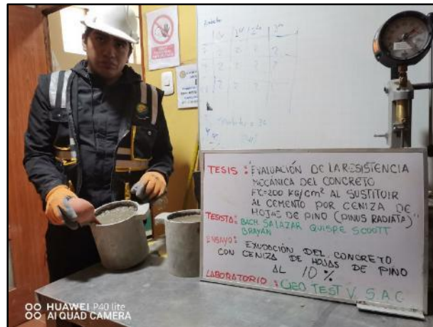
Fotografía N° 25: Control de la exudación del concreto con 10% de ceniza de hojas de pino, según referencia de la norma NTP 339.077.
