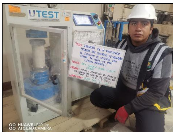
Fotografía N° 56: Testigos cilíndricos incorporados el 10% de ceniza de hojas de pino para la resistencia a la compresión de los 7 días de edad, según referencia de la norma NTP 339.034 / ASTM C39.
