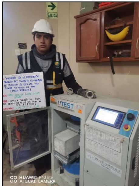
Fotografía N° 91: Testigos cilíndricos incorporados el 14% de ceniza de hojas de pino para la resistencia a la flexión de los 28 días de edad, según referencia de la norma NTP 339.034 / ASTM C39.
