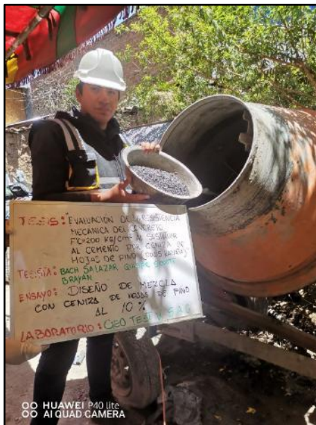
Fotografía N° 20: Vista particular de la ceniza de hojas de pino con peso requerido del 10% para su mezcla del concreto. NTP 339.183.
