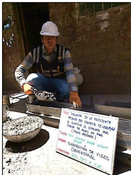
Fotografía N° 16: Elaboración de testigos rectangulares convencionales para sus respectivos tipos de ensayos. NTP 339.034 / ASTM C39.
