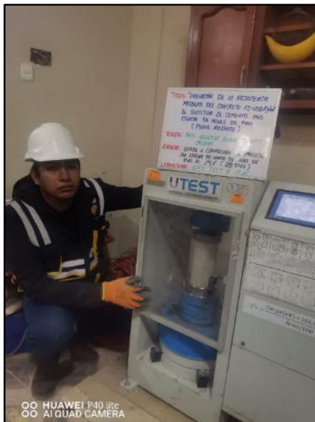
Fotografía N° 72: Testigos cilíndricos incorporados el 14% de ceniza de hojas de pino para la resistencia a la compresión de los 28 días de edad. NTP 339.034 / ASTM C39.
