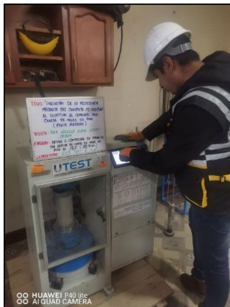
Fotografía N° 66: Testigos cilíndricos incorporados el 12% de ceniza de hojas de pino para la resistencia a la compresión de los 28 días de edad. NTP 339.034 / ASTM C39.
