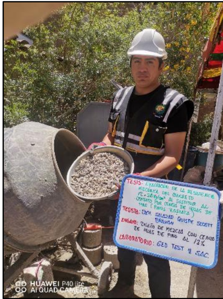
Fotografía N° 29: Vista de materiales tales como el agregado grueso para la elaboración del concreto con adición del 12% de ceniza de hojas de pino. NTP 339.183.
