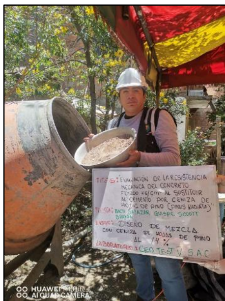
Fotografía N° 40: Vista de materiales tales como el agregado fino para la elaboración del concreto con adición del 14% de ceniza de hojas de pino, según referencia de la norma NTP 339.183.
