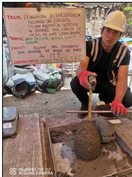
Fotografía N° 44: Medición del asentamiento del concreto fresco con adición del 14% de ceniza de hojas de pino. Según NTP 339.035.
