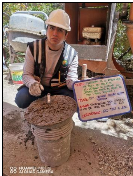
Fotografía N° 32: Medición de la temperatura del concreto saliendo de la mezcladora con adición del 12% de ceniza de hojas de pino. NTP 339.184.
