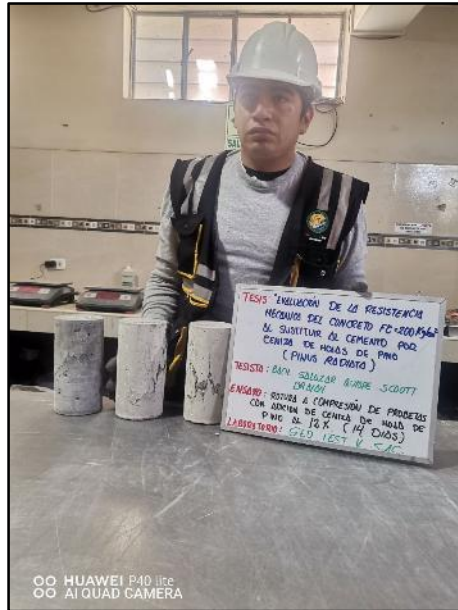
Fotografía N° 65: Testigos cilíndricos incorporados el 12% de ceniza de hojas de pino para la resistencia a la compresión de los 14 días de edad, según referencia de la norma NTP 339.034 / ASTM C39.
