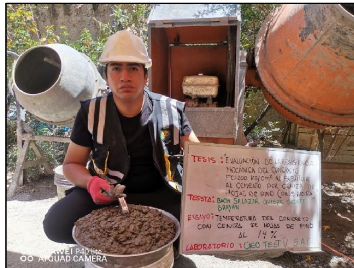
Fotografía N° 43: Medición de la temperatura del concreto saliendo de la mezcladora con adición del 14% de ceniza de hojas de pino. NTP 339.184.
