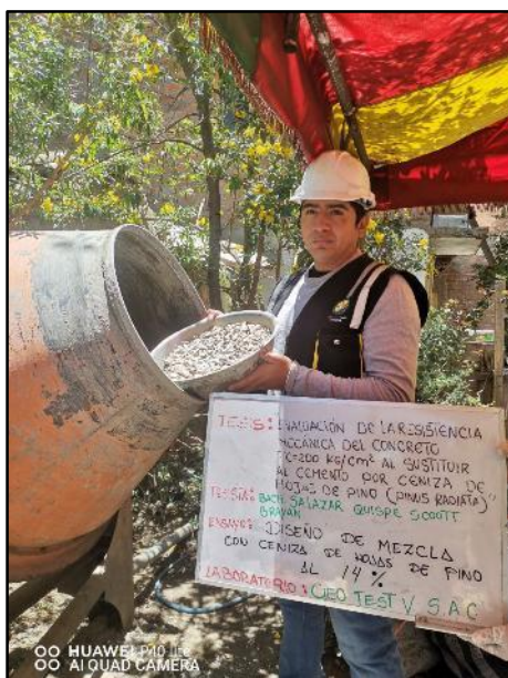
Fotografía N° 39: Vista de materiales tales como el agregado grueso para la elaboración del concreto con adición del 14% de ceniza de hojas de pino. NTP 339.183.
