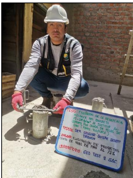
Fotografía N° 37: Elaboración de testigos cilíndricos con adición del 12% de ceniza de hojas de pino para sus respectivos tipos de ensayos, según referencia de la norma NTP 339.034 / ASTM C39.
