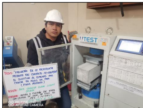
Fotografía N° 90: Testigos cilíndricos incorporados el 14% de ceniza de hojas de pino para la resistencia a la flexión de los 14 días de edad. NTP 339.034 / ASTM C39.
