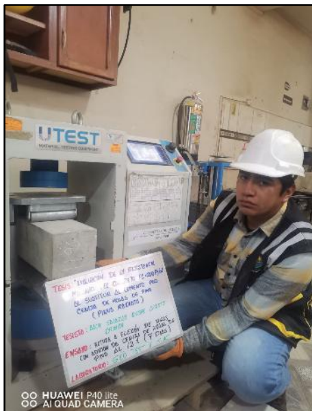
Fotografía N° 86: Testigos cilíndricos incorporados el 12% de ceniza de hojas de pino para la resistencia a la flexión de los 7 días de edad. NTP 339.034 / ASTM C39.
