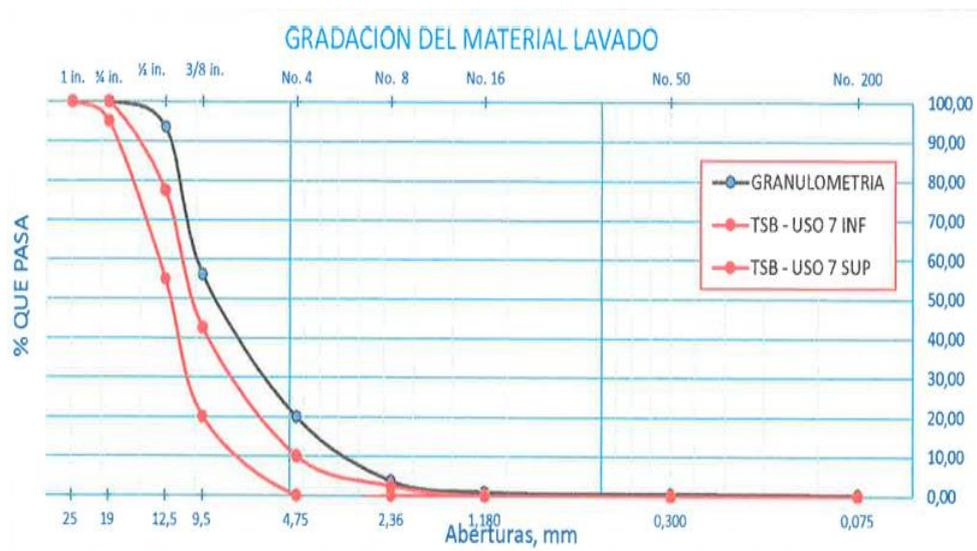
**Figura 33.** Curva granulométrica de del material asfáltico lavado M1 progresiva Km 3+930- Izquierdo
