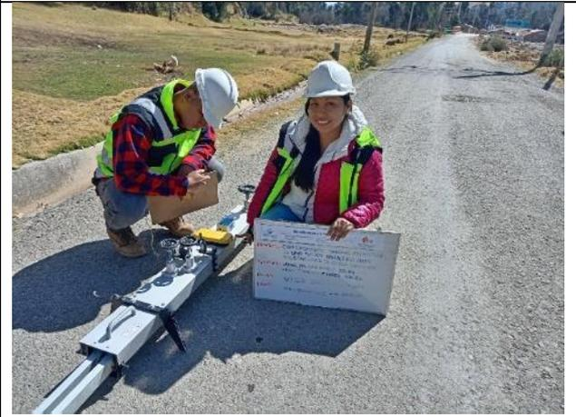
Fotografía N° 2: Ensayo de Viga Benkelman en el tramo.
