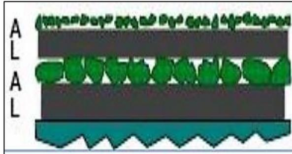
**Figura 7:** Esquema del tratamiento superficial doble.
