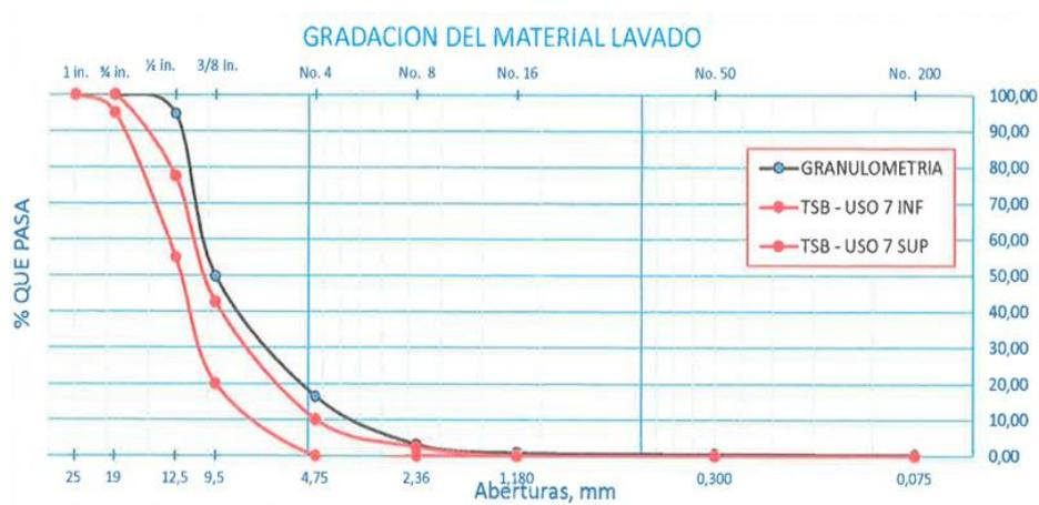
**Figura 32.** Curva granulométrica de del material asfáltico lavado M2 progresiva Km 3+300 - Izquierdo
