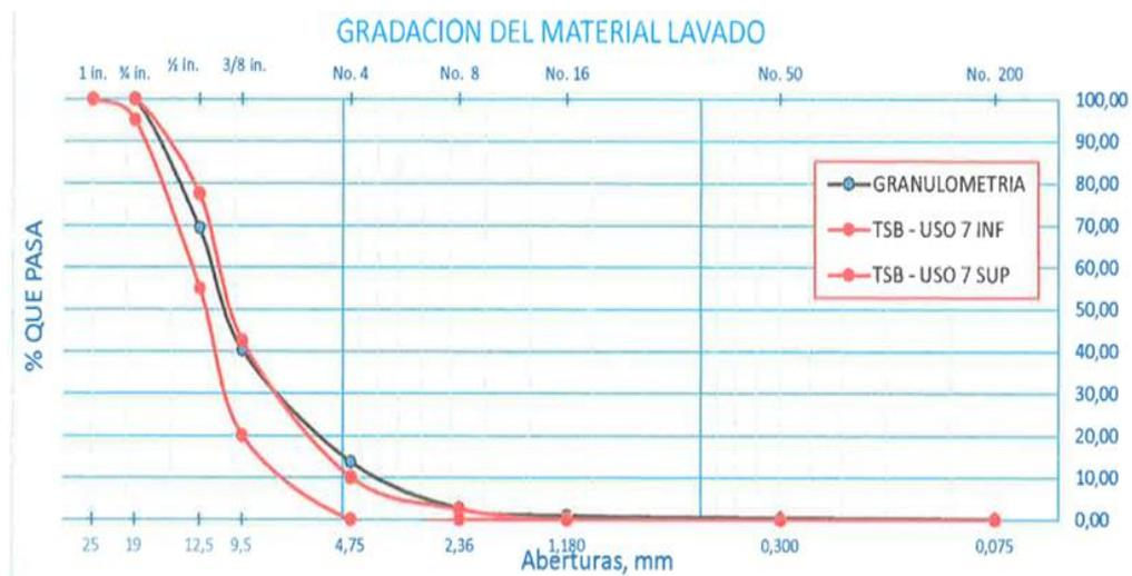
**Figura 30.** Curva granulométrica del material asfáltico lavado M2 progresiva Km 2+920 - Derecho
