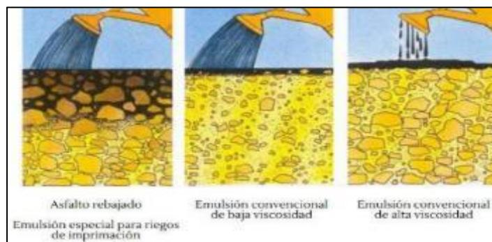
**Figura 5:** Tipo de emulsión al ubicar el riego de imprimación.
