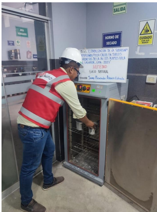
Fotografía 7. Prueba de OCH en muestras del suelo convencional, según la NTP, 339.127
