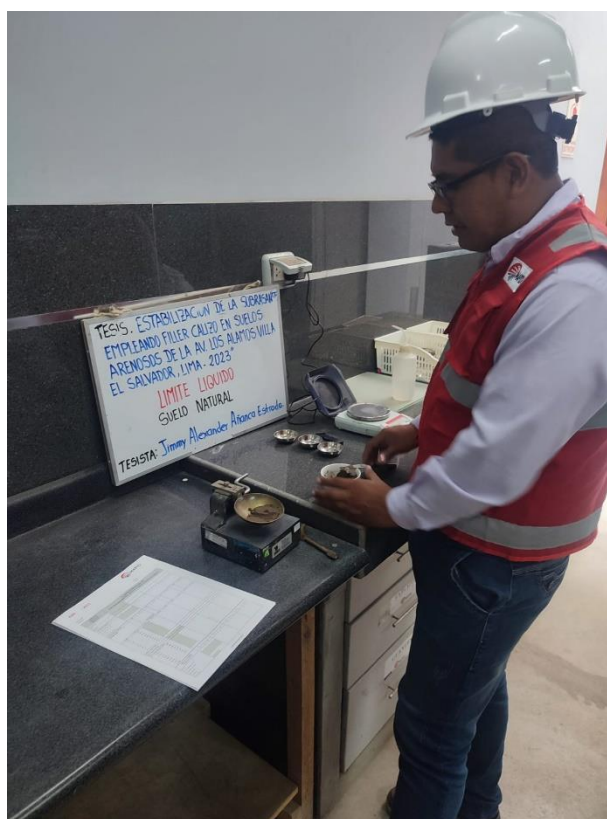
Fotografía 8. Prueba de LL en la muestra natural de acuerdo con la MTC E 110.
