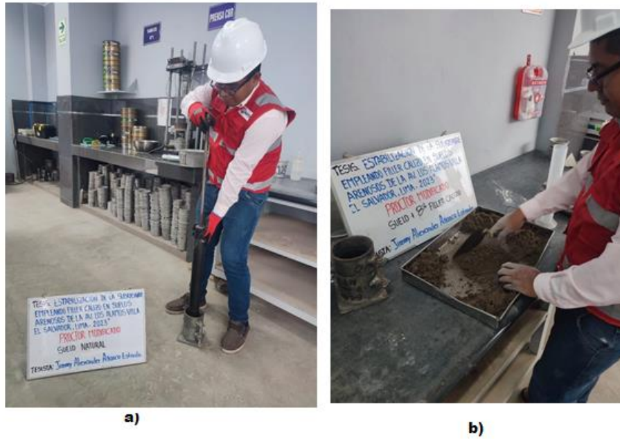
Fotografía 9. Prueba de Proctor modificado de acuerdo con la norma MTC E 115
