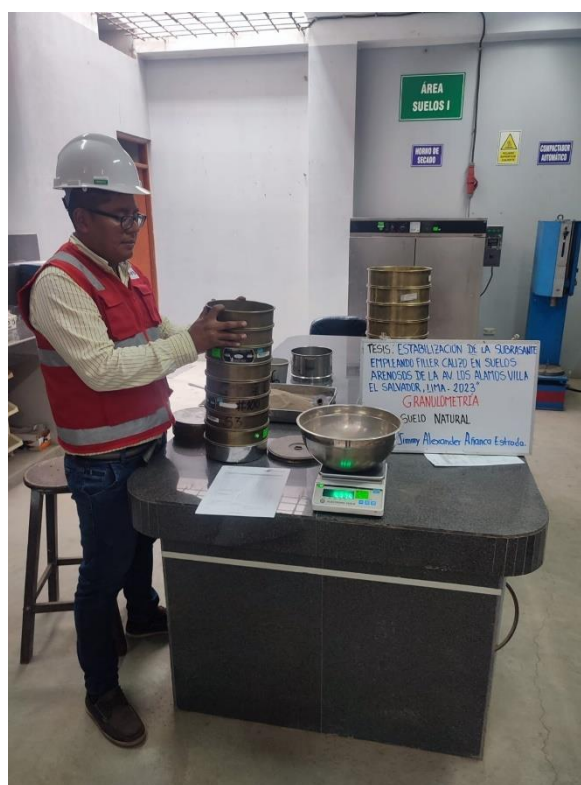
Fotografía 6. Análisis de granulometría de la muestra en función la MTC E 107
