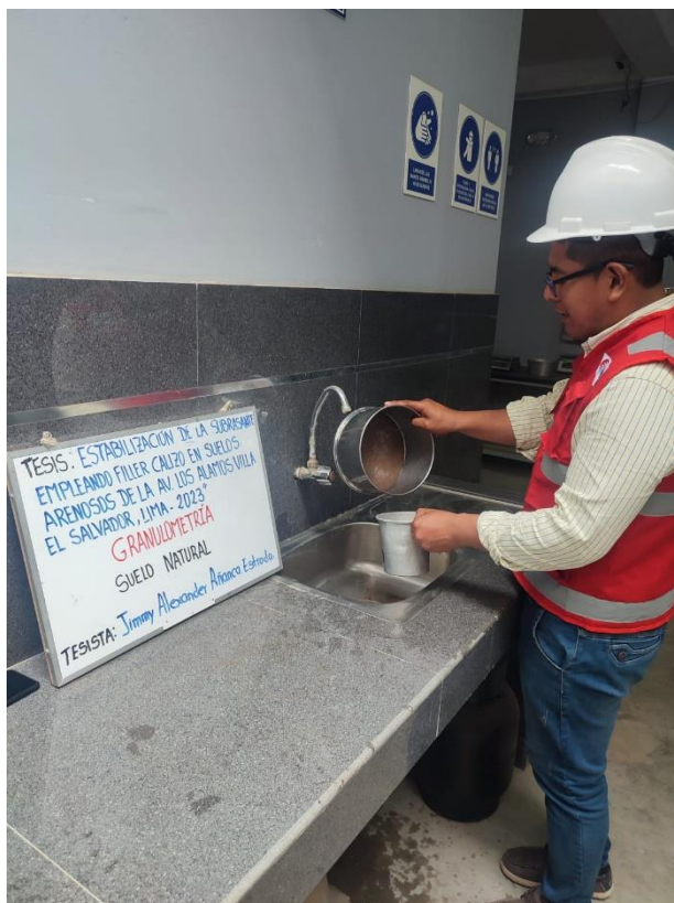
Fotografía 5. Proceso de lavado de las muestras obtenidas en campo para realizar la prueba de granulometría de acuerdo al MTC E 107
