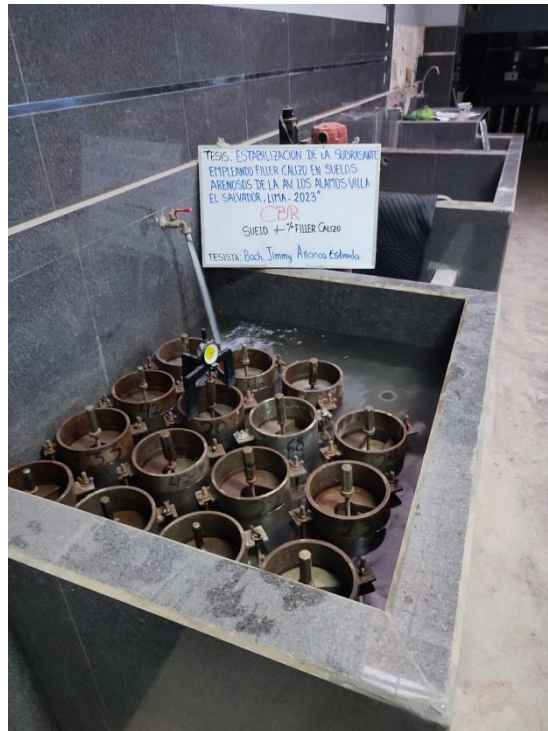
Fotografía 11. Muestras de suelo control y muestras experimentales del ensayo de CBR
