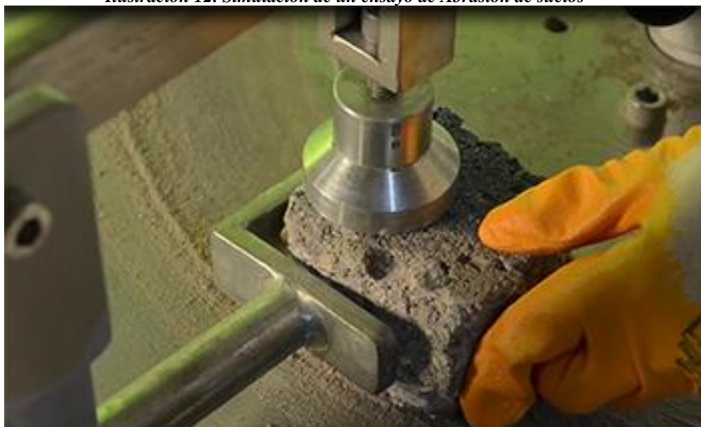
Ilustración 12. Simulación de un ensayo de Abrasión de suelos
