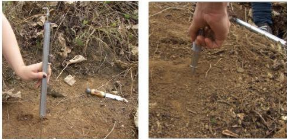
Ilustración 10. Representación de la determinación de resistencia a la penetración
