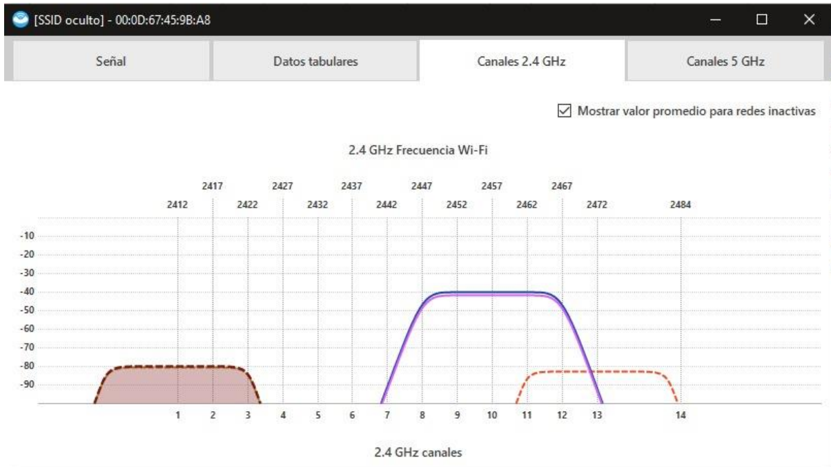
Figura 20: Frecuencia de canales en 2.4 GHz en el IESTP de "Nuevo Occoro"
