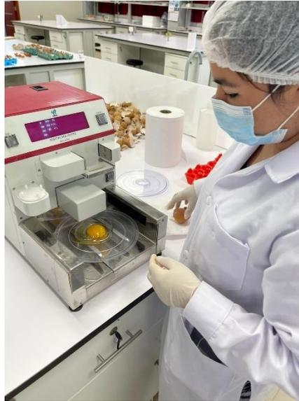
**Ilustración 14:** Análisis del huevo, (peso, resistencia de la cascara, unidad Haugh, altura de yema, altura de albumen, índice de yema, diámetro de yema y color de yema)
