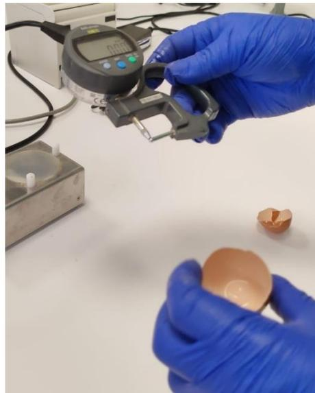
**Ilustración 17:** Evaluación del grosor de la cascara con el micrómetro.
