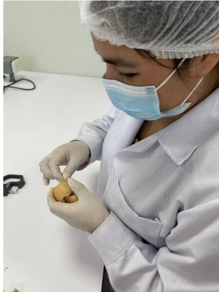
**Ilustración 16:** Extracción de la parte roma superior, la punta y la línea ecuatorial de la cascara para la evaluación del grosor de la cascara con el micrómetro.
