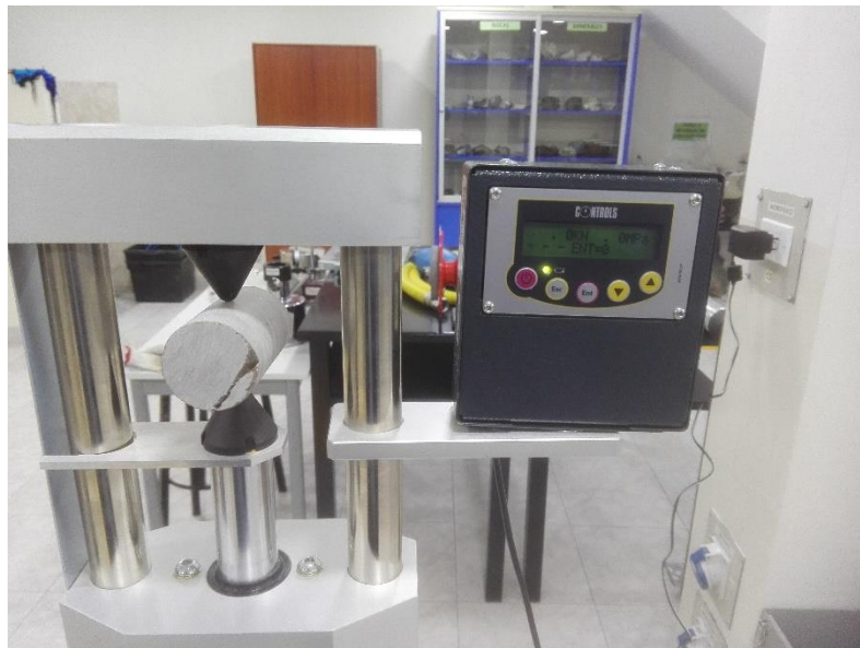
FIGURA 96 se observa el testigo sometido a la carga puntual.
