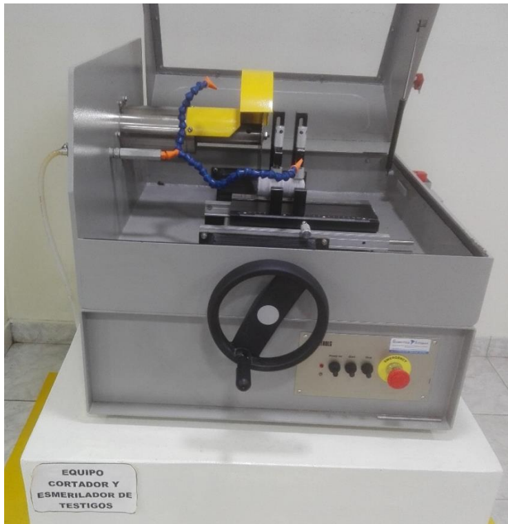
FIGURA 92 se observa al grupo cortador y esmerilador de testigos.
