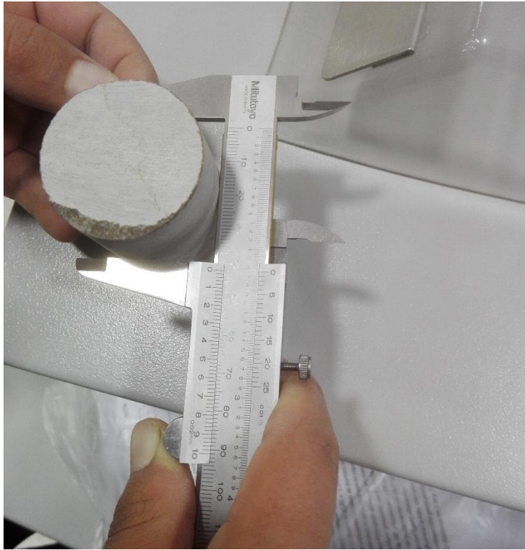
FIGURA 95 se comprueba que el diámetro del testigo sea de 52 mm.
