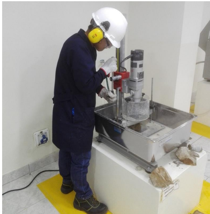
FIGURA 90 se extrae un testado de diámetro de 52 mm.
