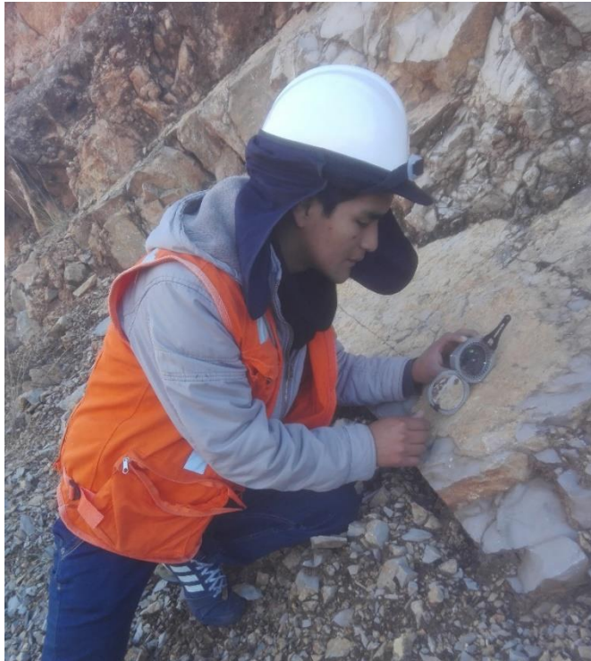
FIGURA 87 Medición del Rumbo de las discontinuidades del macizo rocoso.
