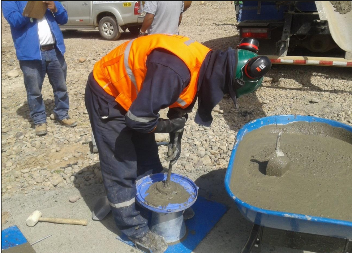
FOTOGRAFÍA N° 27 Ensayo de revenimiento con el cono de Abrams.
