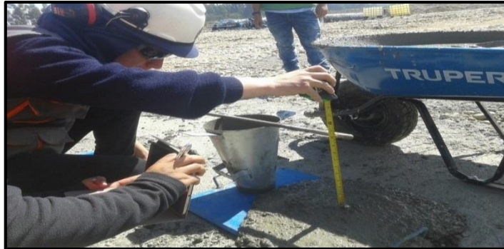
FOTOGRAFÍA N° 4.2 Ensayo de expansión de flujo y medición del revenimiento.
