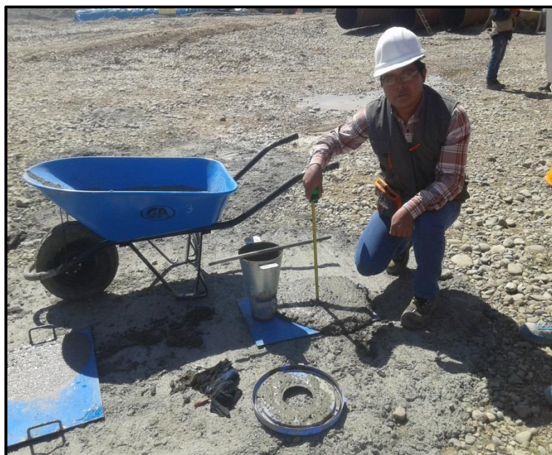
FOTOGRAFÍA N° 4.1 Prueba de revenimiento con cono de Abrams al concreto auto compactante.
