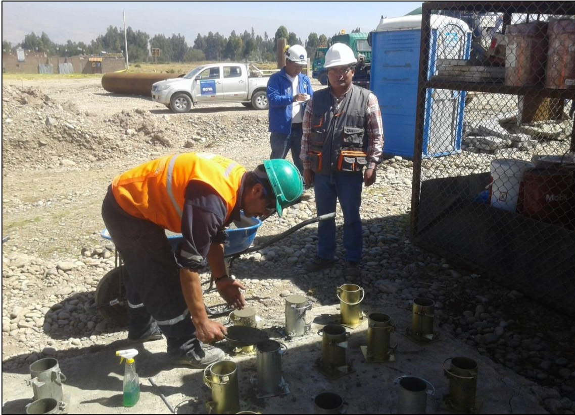
FOTOGRAFÍA N° 29 Toma de muestras del concreto para la realización del ensayo a compresión.
