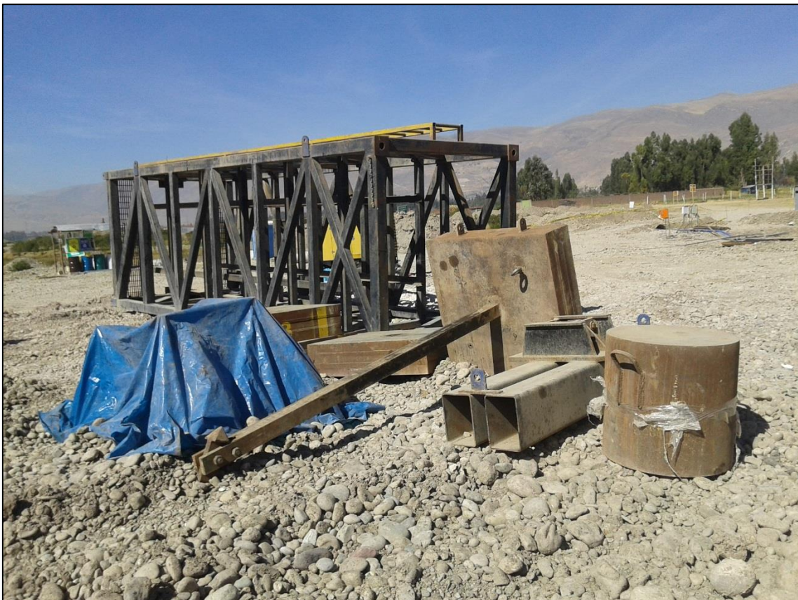
FOTOGRAFÍA N° 36 Armazón de acero para la realización de la prueba de carga dinámica.
