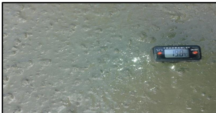
FOTOGRAFÍA N° 4.3 Medición de la temperatura del concreto auto compactante.
