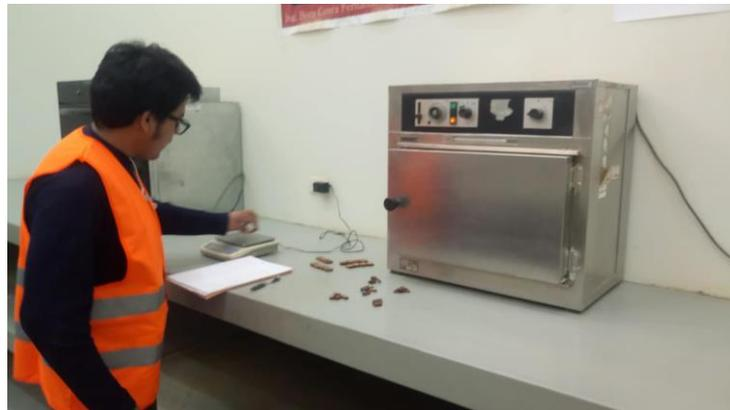
***Determinación del contenido de humedad del bambú en el laboratorio de suelos en la universidad peruana los andes utilizando un horno eléctrico.***
