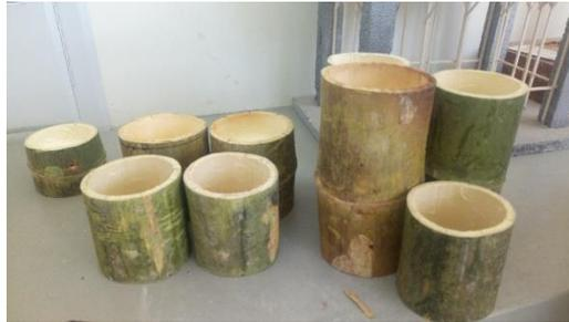
*FIGURA N° 50, Probetas de bambú*
