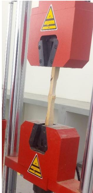
*FIGURA N° 54, Ensayo a tracción*
