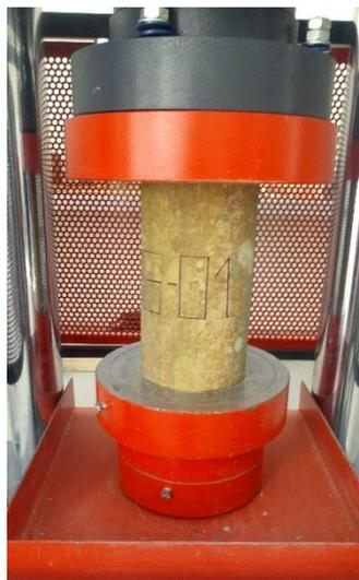
*FIGURA N° 51, Ensayo compresión*
