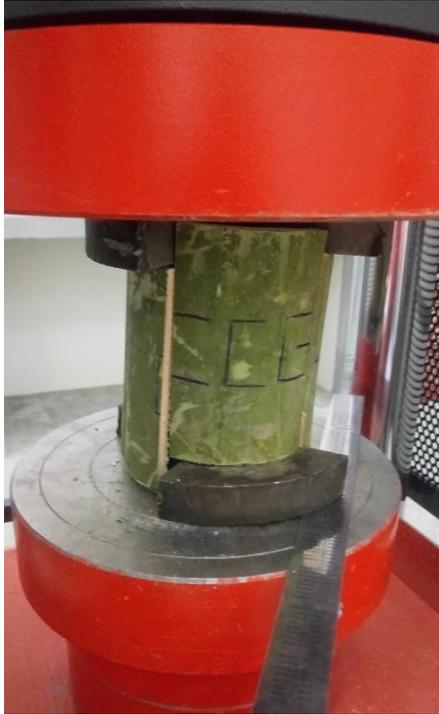
***Ensayos a corte de los culmos de bambú de alturas iguales (De) en el laboratorio de estructuras de la universidad peruana los andes en la maquina maquina a compresión modelo MES- 150.***
