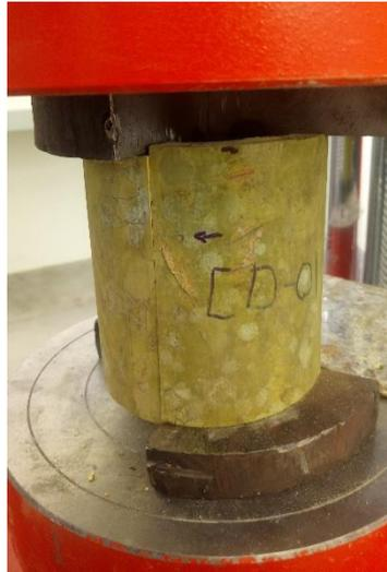
*FIGURA N° 52, Ensayo a corte del bambú*
