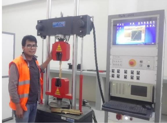
***Ensayos a tensión del bambú en el laboratorio de estructuras de la universidad peruana los andes en la maquina maquina a tracción modelo ME- 403-30.***
