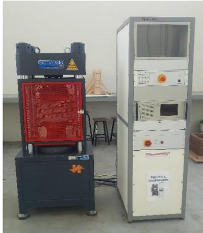
FIGURA N° 48, Maquina a compresión "servosis testing machines" Mod: MES- 150
