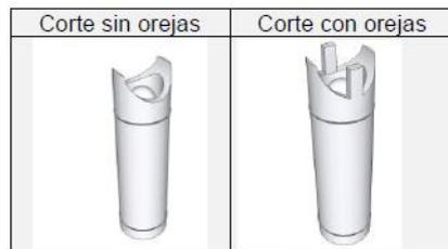
*FIGURA N° 37, Corte boca de pescado*
