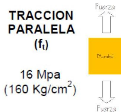
FIGURA N° 13, Tracción paralela
