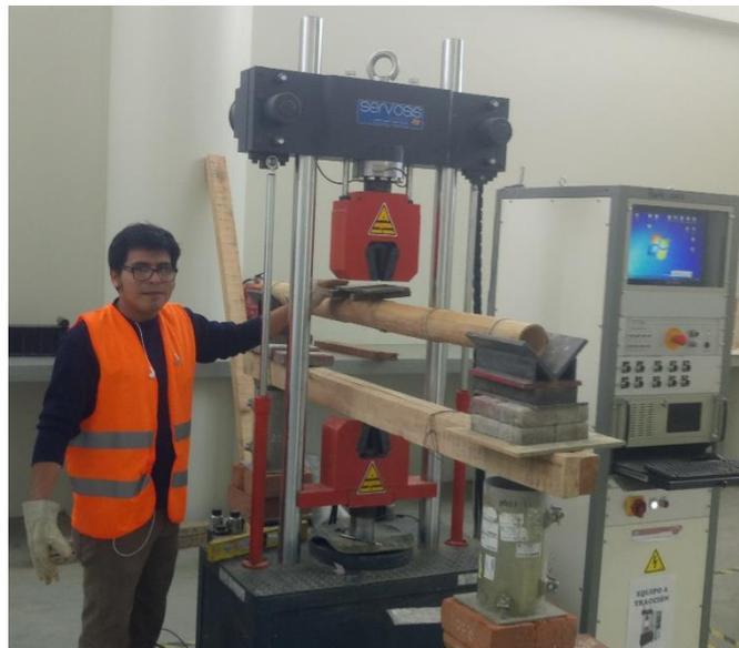
***Ensayos a flexión de una barra de bambú en el laboratorio de estructuras de la universidad peruana los andes en la maquina a tracción modelo ME- 403-30 que se tuvo que adecuar para realizar el ensayo a flexión.***
