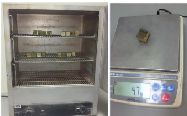
FIGURA N° 55, Secado y pesado de las muestras
