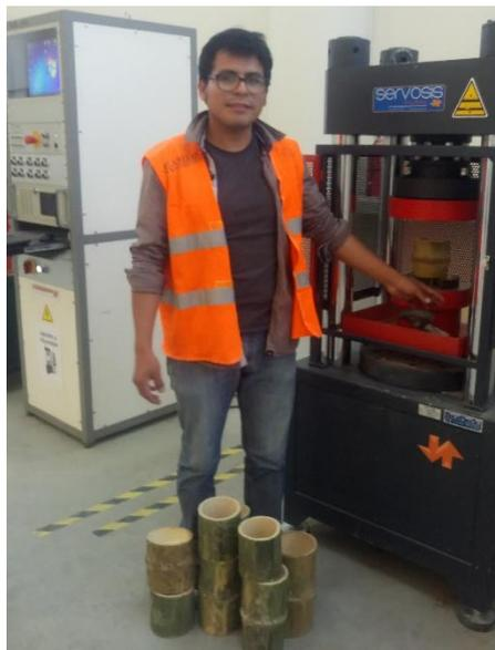
***Ensayos a compresión de culmos de bambú de alturas iguales (2De) en el laboratorio de estructuras de la universidad peruana los andes en la maquina maquina a compresión modelo MES- 150.***
