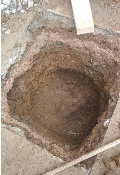
***Toma de muestras para el ensayo de capacidad portante en la municipalidad provincial de satipo a una altura de 2 metros.***
